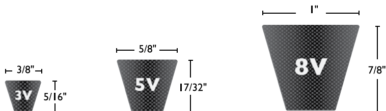
Fig 5. Sección de correas en "V" de Alta Capacidad tamaño real.
